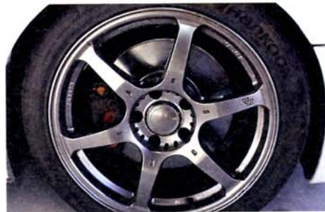
富士の事前テストで「900」パッドと12本スリットのローターをテストしたが、パッドが削れ過ぎ高温時にフェードとジャダーが発生。それを抑えるためにロアアームに潮風板を付け、ローターをブレンに変更した
